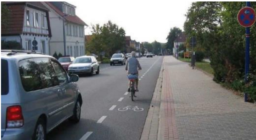
Obr. 77: Příklad víceúčelového pruhu - SRN [zdroj: [25]]
