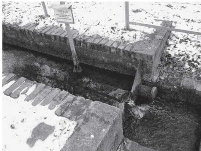
Zařízení k měření vydatnosti pramene (foto Jiří Wagner)
