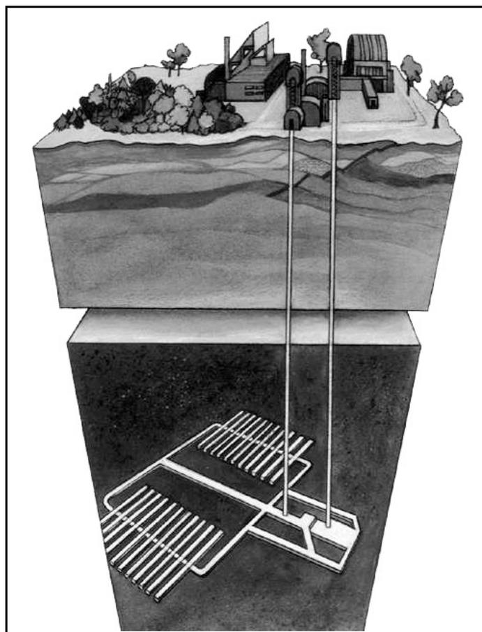
*Základní schéma hlubinného úložiště radioaktivních odpadů. Areál na povrchu země spojují s ukládacími prostorami několik set metrů pod zemí přístupové a větrací šachty. Prostor úložiště vysoce nebezpečných jaderných odpadů v hloubce cca 800 m, který plánuje vláda ČR umístit do našeho kraje v Pošumaví, má mít těžko představitelnou rozlohu 190 ha.*
